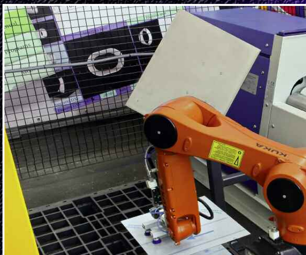
• Impianto con robot per posizionamento lamiera • Plate loading and unloading robot system • Système avec robot pour le chargement et le déchargement des tôles • Sistema con robot para cargar y descargar la chapa
