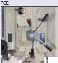
TCE Detalle del embrague electromagnético automático. Detail of automatic electromagnetic clutch. Détail de l'embrayage électromagnétique automatique. Detail der automatischen Elektromagnetkupplung.
